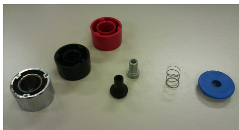
Figura 8 - Foto do corpo nas três cores (preta, prata e rosa), do pino nas duas cores (preta e cinza), mola e tampa (azul).
