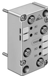
Figura 23 - Módulo ASI utilizado no projeto (SIEMENS, 2008).
